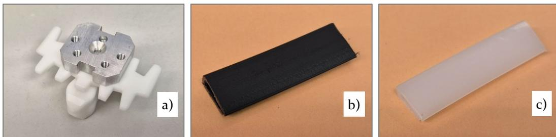
**Abbildung 8:** Probekörper für die Bauteilversuche; a) Oberprobe Kettenglied, b) Gleitprofil aus antistatischem PE-HD, c) Profil aus gleitmodifiziertem PE-UHMW
