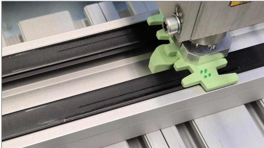
**Abbildung 20:** Glättungsspuren am Gleitprofil aus PE-HD nach 168 h Versuchsdauer mit Kettenglied V4
