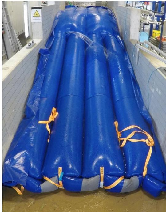
**Abbildung 6:** Binnenböschung mit dem TeD-Modul nach 24 h mit Wasseraustritt am Modul; Erosion unterhalb des Moduls (ausgetragener Sand am Deichfuß) (Krebs und Schüttrumpf 2019)
