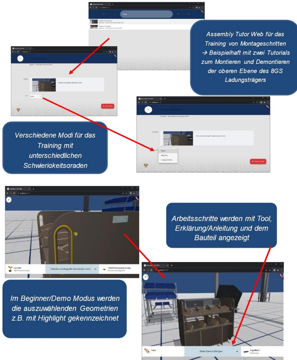
Abbildung 4: Assembly Tutor Web-App – Auszug aus einem Workflow am Beispiel des Ladungsträgers 8GS der ligenium GmbH und ausgewählte Funktionalitäten
