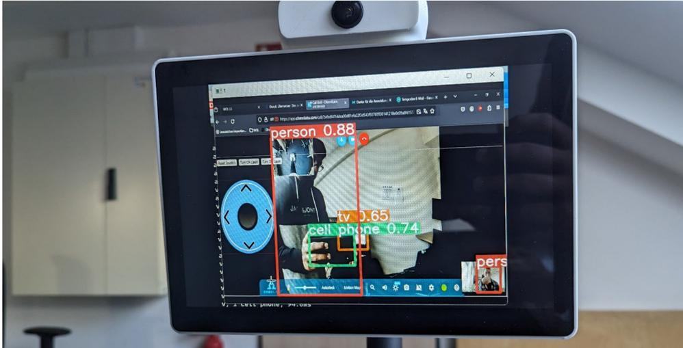
Abbildung 1: Anwendung der YOLO-Objekterkennung auf dem Ohmni TPR
